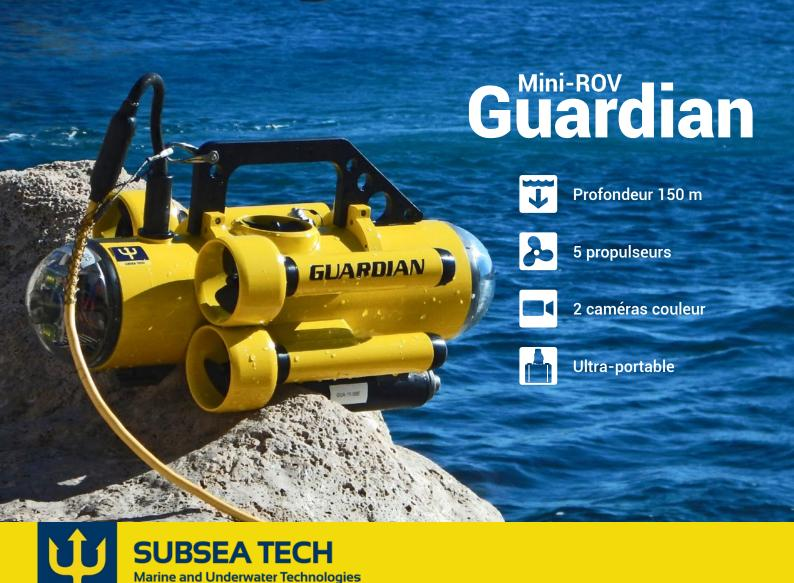
**Le Mini-ROV Guardian** est un robot sous-marin d'inspection portable, équipé de 4 propulseurs horizontaux et d'un propulseur vertical, capable d'opérer jusqu'à 150 m de profondeur. Il est équipé de 2 caméras couleur haute résolution (1 caméra full HP en version IP), dont une montée sur une tourelle Pan & Tilt, offrant des inspections sur des distances jusqu'à 500 m en option longue distance.
