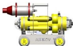
**PIPESCANNER (LASER en air OU ACOUSTIQUE en eau)**
