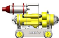
PIPESCANNER (LASER en air OU ACOUSTIQUE en eau) Chariot téléopéré équipé d'un sonar profileur ou scan laser
