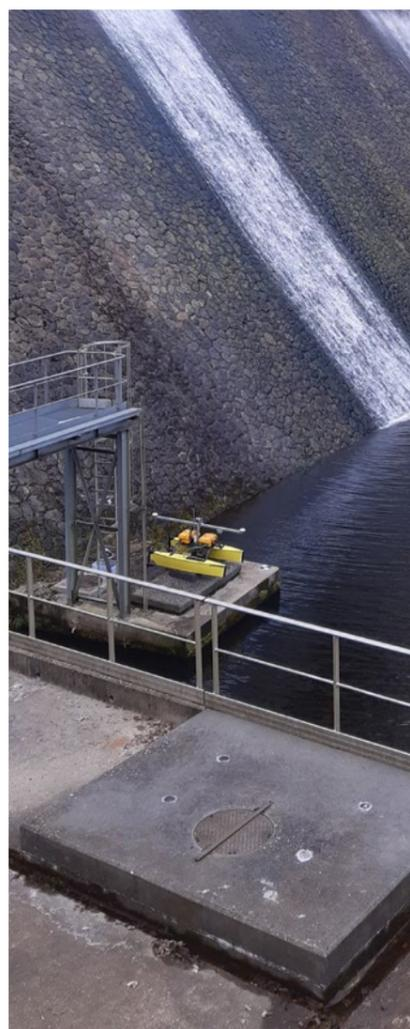
La première équipe s'est occupée d'effectuer des levés bathymétriques en amont et en aval du barrage par drone de surface :
